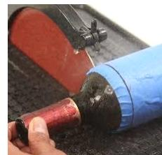
岩石、鉱石、ガラス、樹脂製品等の湿式切断に適しています。
