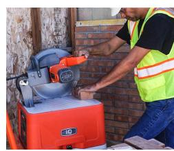
正常使用下でのカット時の粉塵を 99% 吸引します
