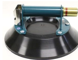
パワーグリップ 10 インチ MT (曲げガラス, 平板用) (米) 安全荷重 79kg 最大荷重 316kg 吸盤径: \phi 254\text{mm}
