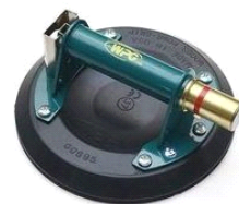
パワーグリップ 8 インチ MT (平板用) (米) 安全荷重 57kg 最大荷重 228kg 吸盤径: \phi 204\text{mm}
