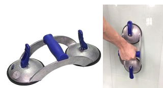
パワーグリップ 10 インチ MT (曲げガラス, 平板用) (米) 安全荷重 79kg 最大荷重 316kg 吸盤径: \phi 254\text{mm}
