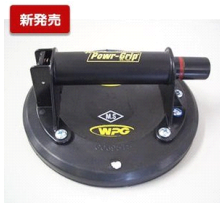
パワーグリップ 8インチ P-K (型板用) (米) 安全荷重 34kg 最大荷重 136kg 吸盤径: \phi 204\text{mm}
