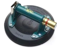
パワーグリップ 8インチ MT (平板用) (米) 安全荷重 57kg 最大荷重 228kg 吸盤径: \phi 204\text{mm}
