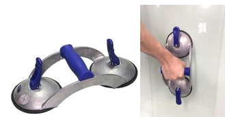
パワーグリップ 10インチ MT (曲げガラス, 平板用) (米) 安全荷重 79kg 最大荷重 316kg 吸盤径: \phi 254\text{mm}
