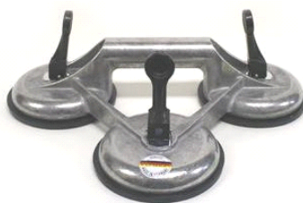
アルミ製3カップ吸着盤 最大荷重: 90kg (独) 吸盤直径: \phi 120\text{mm} \times 3 個
